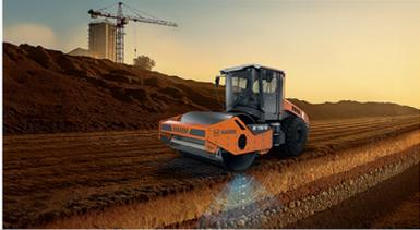
**Automatische Verdichtung auf Zielwert – neuer Walzenzug HC 130i C VA**
